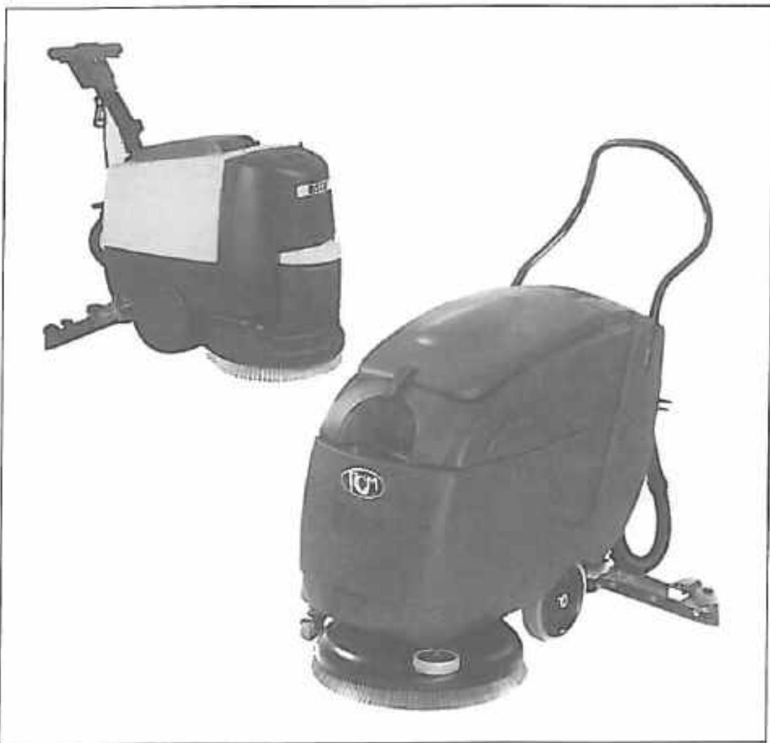
در انتهای دستگاه یک تی قرار گرفته که توسط یک خرطومی به مخزن آب کلیف و موتور مکش متصل است. با ادامه حرکت دستگاه آب کلیف ایجاد شده در مرحله شستشوی سطح توسط تی عقب به صورت کامل جمع آوری شده و به کمک موتور مکش دستگاه به داخل مخزن آب کلیف ریخته می‌شود.
