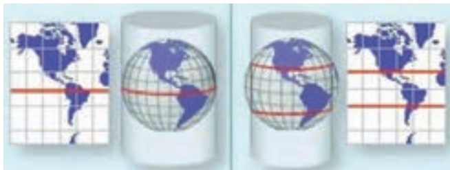
شکل ۳- سیستم مرکاتور مماسی و متقاطع
