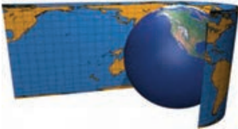
شکل ۲- مسطح کردن صفحه فرضی محاط بر دور کره زمین در سیستم تصویر مرکاتور
