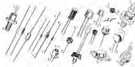
شکل ۲۱-۱۳ شکل ظاهری چند نمونه دیود
