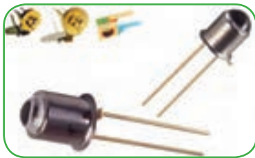
شکل ۴۲-۱۳- شکل ظاهری چند نمونه فتو دیود
