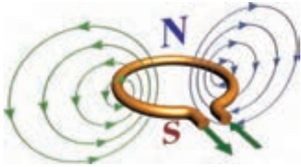
شکل ۱۷-۸ - میدان مغناطیسی حاصل در یک حلقه
