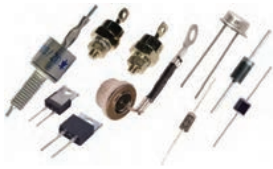
شکل ۲۴-۱۳- چند نمونه دیود یک‌سوکننده معمولی
