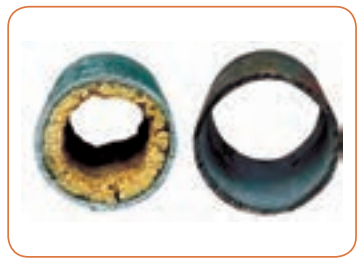
مقایسه دو لوله کار کرده در دو حالت آب سختی‌گیر شده (treated) و آب سختی‌گیر نشده (untreated)
