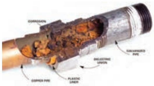
خوردگی لوله فولادی گالوانیزه در اتصال با لوله مسی
