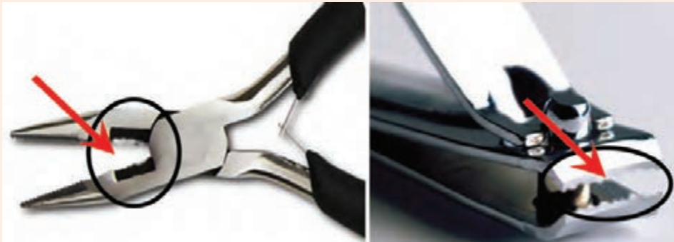
شکل ۵-۱۹ - لبه‌های برنده خراب شده در ناخن گیر و دم باریک
