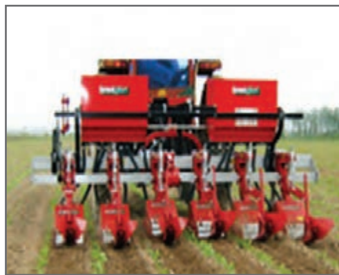
انواعی از کولتیواتورهای داشت در حال انجام عملیات مکانیزه خاک‌دهی پای بوته
