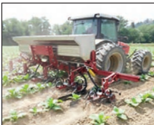
انواعی از کولتیواتورهای داشت در حال انجام عملیات مکانیزه خاک‌دهی پای بوته
