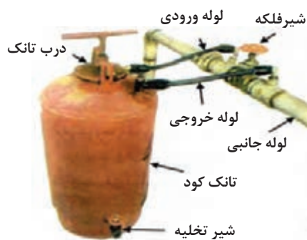
شکل ۲۸- اجزای سیستم توزیع کود
