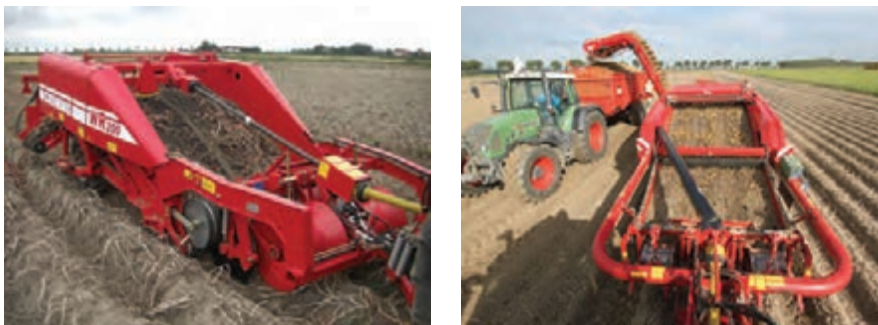
شکل ۲۷- برداشت سیب‌زمینی با دستگاه کمباین
