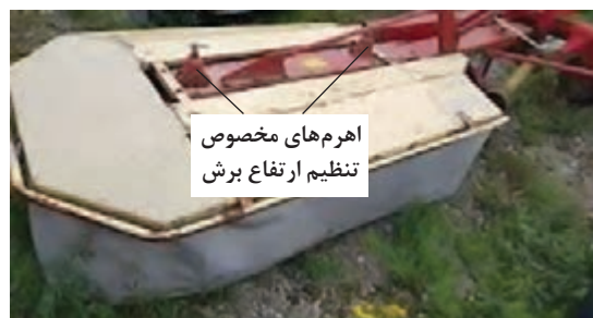
شکل ۲۸- اهرم‌های مخصوص تنظیم ارتفاع برش
