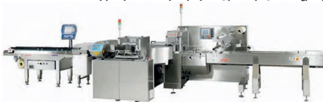
ماشین بسته‌بندی به روش اتمسفر اصلاح شده
