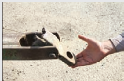
شکل ۱۸-۴- شکستگی نقطه اتصال و بشقاب
