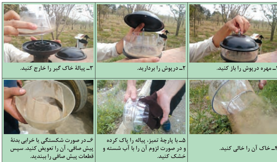
شکل ۳۱-۱- مراحل تمیز کردن پیش صافی
