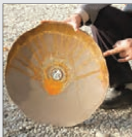
شکل ۱۸-۴- شکستگی نقطه اتصال و بشقاب
