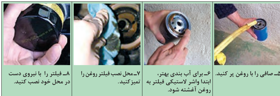
شکل ۵۰-۱- مراحل تعویض صافی روغن
