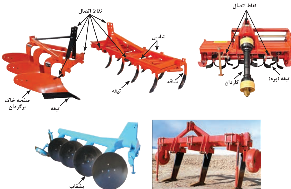
شکل ۱۹-۳- انواع گاوآهن‌ها و نمایش ساختار کلی آن
