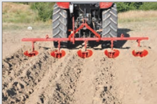
شکل ۳۲-۵- شیارکش در حال ایجاد شیار
