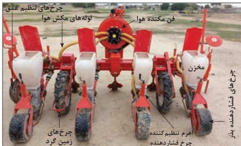
شکل ۷- ساختمان ردیف کار پنوماتیکی بدون کودکار از عقب دستگاه
