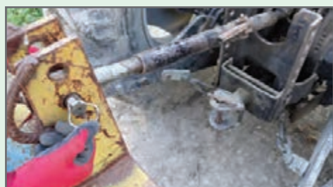
شكل ۲۳- اتصال بازوي وسط تراكتور به نهركن
