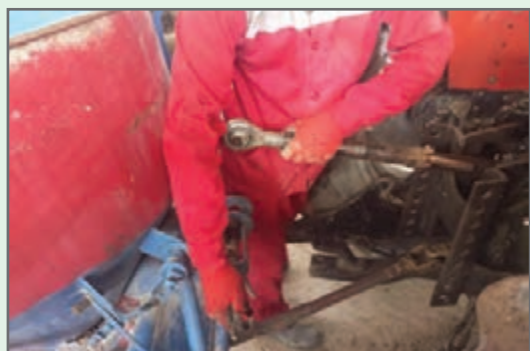
شکل ۱۱- اتصال بازوی وسط تراکتور به بذریاش
