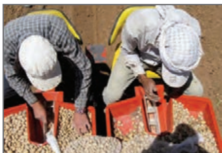
شکل ۴- غده کار نیمه خودکار با موزع افقی مخصوص سیب زمینی‌های ریز
