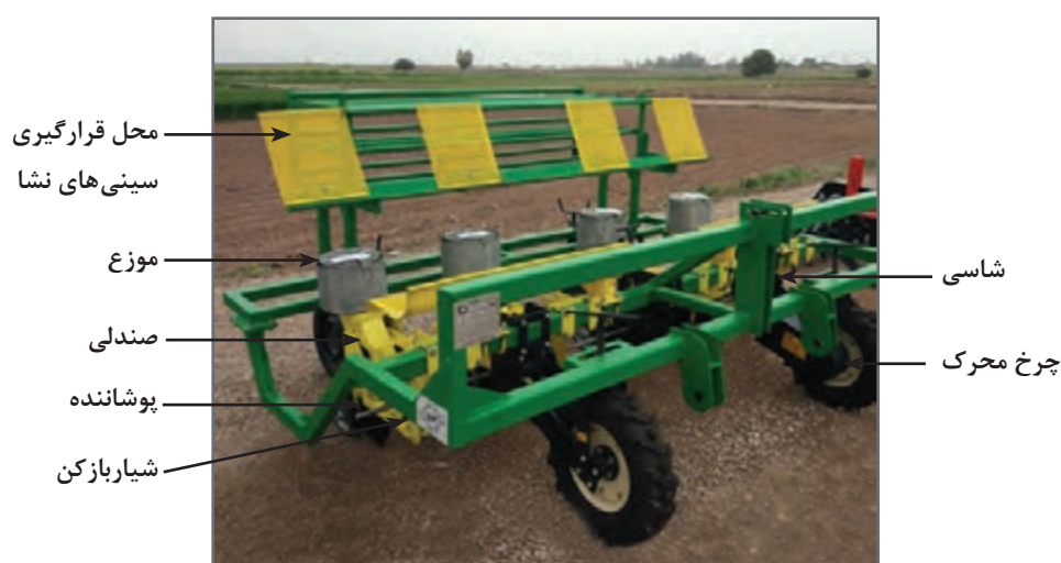
شکل ۴- اجزای ساختمانی یک نمونه نشاکار صیفی
