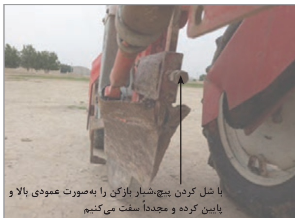
شکل ۲۰- تنظیم شیار بازکن
