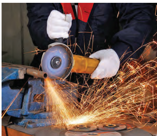
شکل ۲-۲۴ قسمت‌هایی از فلز به دلیل اصطکاک هنگام برش ذوب و بریده می‌شوند.
