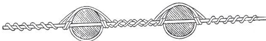
۴- اتصال به کنار دو مقره میخی با دو سیم بست:
