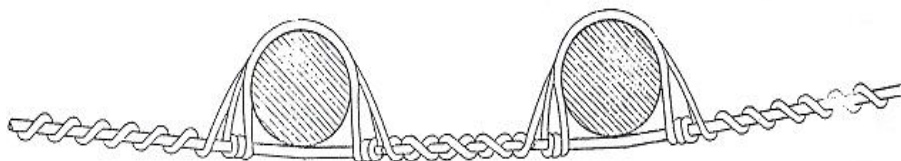
۴- اتصال به کنار دو مقره میخی با دو سیم بست:
