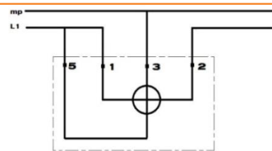
نحوه اتصال سیم پیچ های وات متر در شبکه تکفاز
