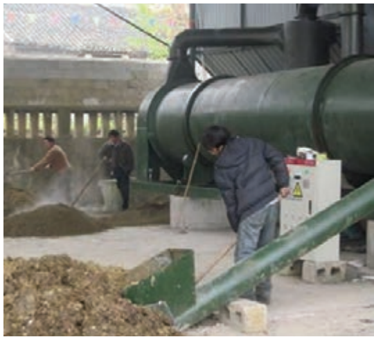
خشک کردن کود مرغ با دستگاه خشک کن
