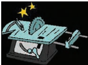
شکل ۳۱- نبود حفاظ در محل‌های متحرک دستگاه
