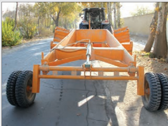
شکل ۱۸-۵- تنظیم وضعیت چرخ ها به روش مکانیکی
