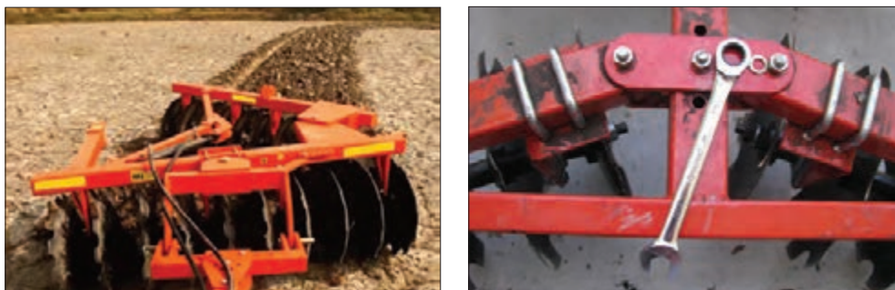
شکل ۲۸-۴ تغییر زاویه استقرار ردیف بشقاب‌ها روی شاسی
