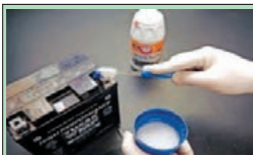
شکل ۱۸- شست و شوی قطب‌ها با جوش شیرین و آب گرم
