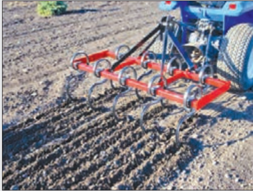
شکل ۳۳-۴ کولتیواتور با شاخه های فنری
