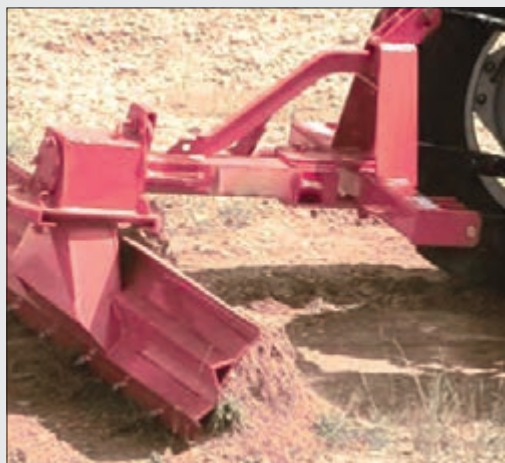
شکل ۲۶-۲ تیغه پشت تراکتوری متصل به تراکتور
