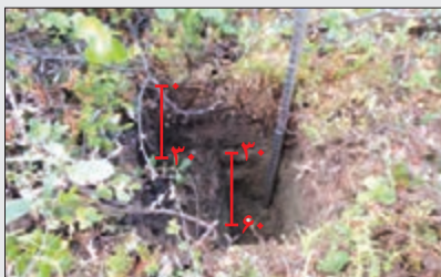
شکل ۱۵-۲- روش نمونه‌برداری از دو عمق ۳۰- و ۶۰- سانتی‌متری
