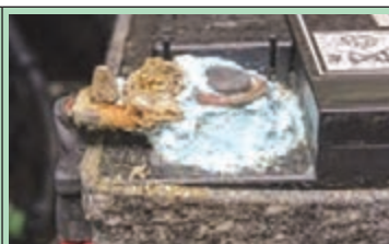
شکل ۱۶- سولفاته شدن قطب‌های باتری
