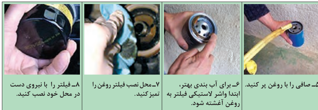
شکل ۵۰-۱- مراحل تعویض صافی روغن
