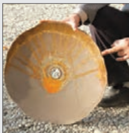
شکل ۱۸-۴- شکستگی نقطه اتصال و بشقاب
