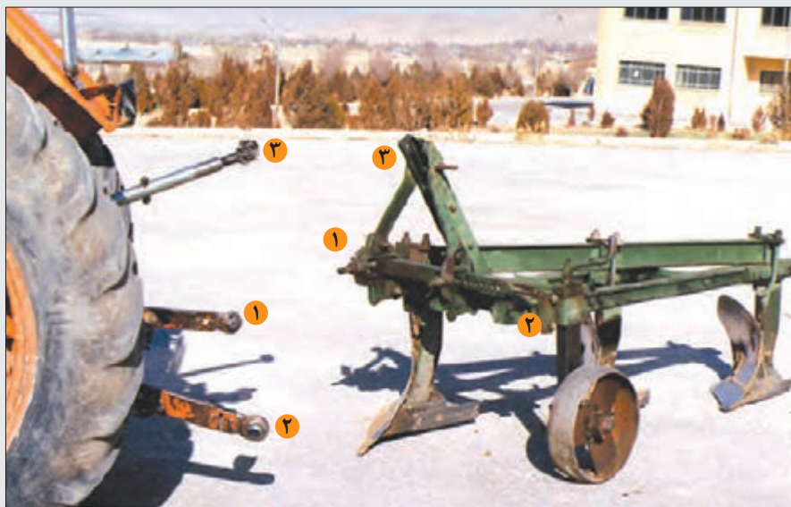
شکل ۲۸-۳- اتصال گاوآهن به تراکتور
