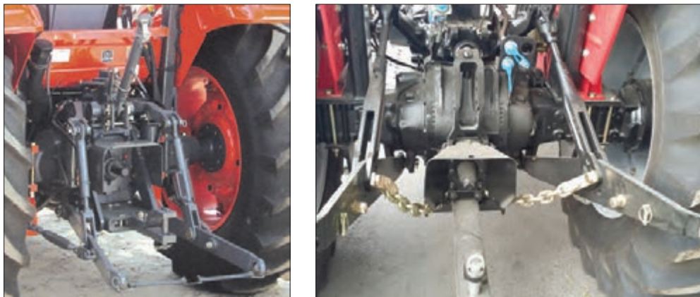
شکل ۳-۳۲- زنجیر تنظیم تعادل یا نوسان گیر
