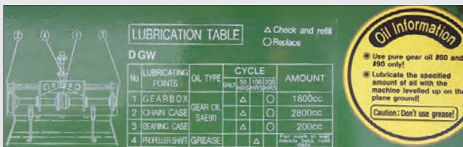
شکل ۲۳-۴ برچسب راهنمای سرویس روی گاوآهن دوار
