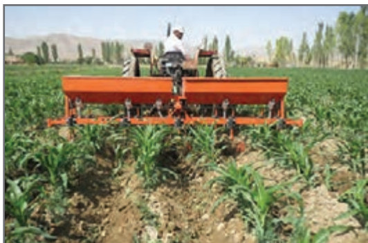
شکل ۴۱- کولتیواتور پنجه ای (غلطان) و یا دستگاه کولتیواتور مرکب با کودکار
