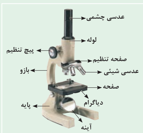
شکل ۲۲- اجزای مختلف نوعی میکروسکوپ
