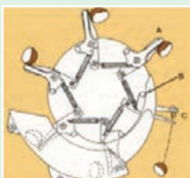
شکل ۷- تصویر شماتیک نحوه کار موزع انگشتی
