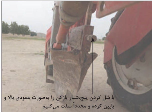
شکل ۲۰- تنظیم شیار بازکن
