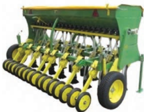
شکل ۳۳- نمونه‌ای ماشین کاشت مستقیم مکانیکی مناسب جهت کشت دیم مدل: rock-۳۰۰۰
