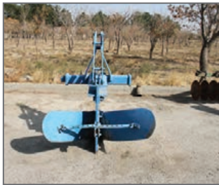
شکل ۲۰- انواع نهركن سوار: ثابت - قابل تنظیم - كناری
