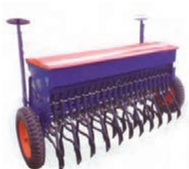
شکل ۵- خطی کار مخصوص کاشت گندم و جو
