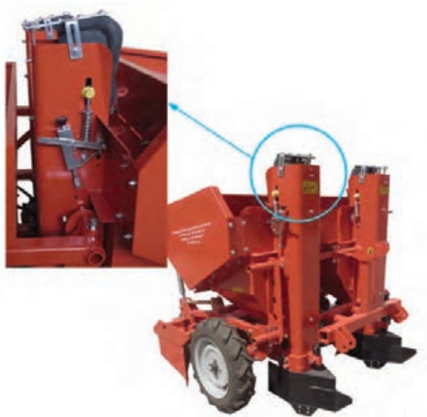
شکل ۱۳- مکانیزم تنظیم کشتش نوار نقاله و تک دانه کن
