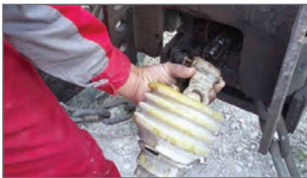
شکل ۱۲- اتصال گاردان به تراکتور
