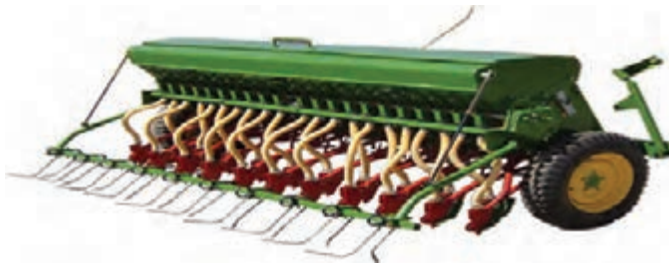
شکل ۳- خطی کار مجهز به دندانه فنی
