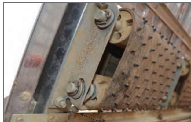
شکل ۲۳- تنظیم کشش تسمه انتقال نشاها
