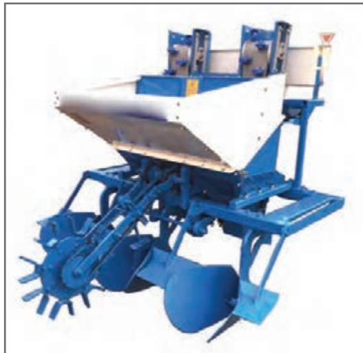
شکل ۵- غده کار خودکار دو ردیفه سوار با موزع پیاله ای
