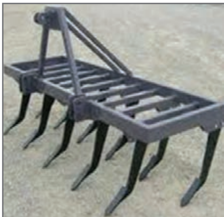
شکل ۱۹- گاوآهن قلمی (اسکنه‌ای یا چیزل) به صورت غیر ترکیبی (مجزا)
