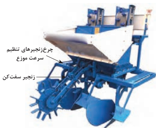
شکل ۱۱- زنجیر و چرخ زنجیر سیستم محرک موزع سیب زمینی کار
