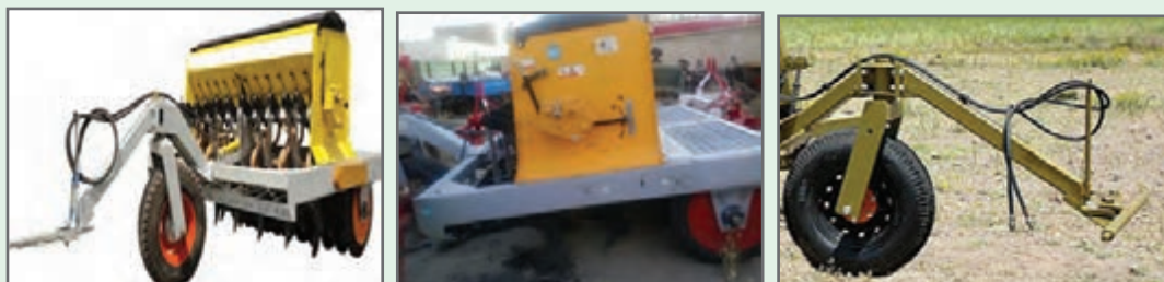
شکل ۴۹- ماشین دیم‌کار کششی با تک نقطه اتصال و شیلنگ‌های هیدرولیک
