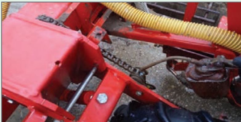
شکل ۱۴- روغن کاری زنجیره و تویی های انتقال نیروی ردیف کار
