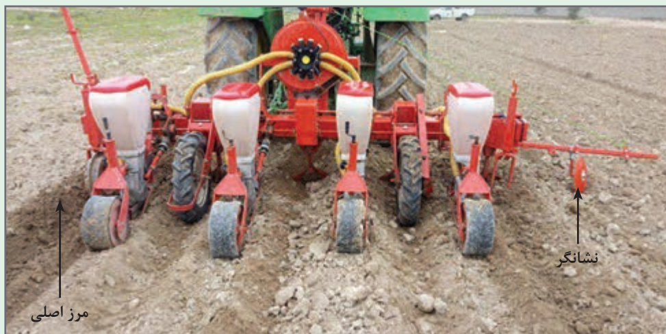
شکل ۲۷- کاشت بذر با ردیف‌کار پنوماتیکی
