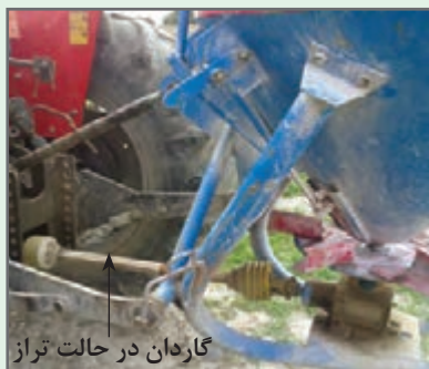
شکل ۱۷- نمایی از موازی بودن گاردان با سطح افق
