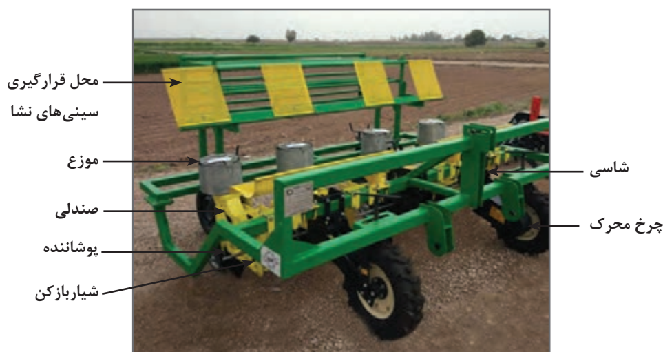
شکل ۴- اجزای ساختمانی یک نمونه نشاکار صیفی
