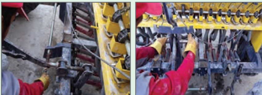
شکل ۱۳- متصل کردن خطی کار به تراکتور
