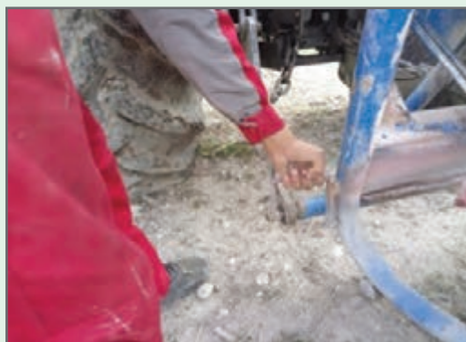
شکل ۹- اتصال بذریاش به بازوهای کناری تراکتور
