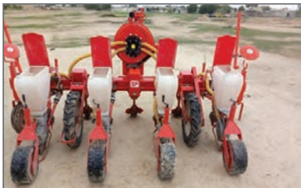
شکل ۲- ردیف‌کار پنوماتیکی (با حذف بخش کودکار)
