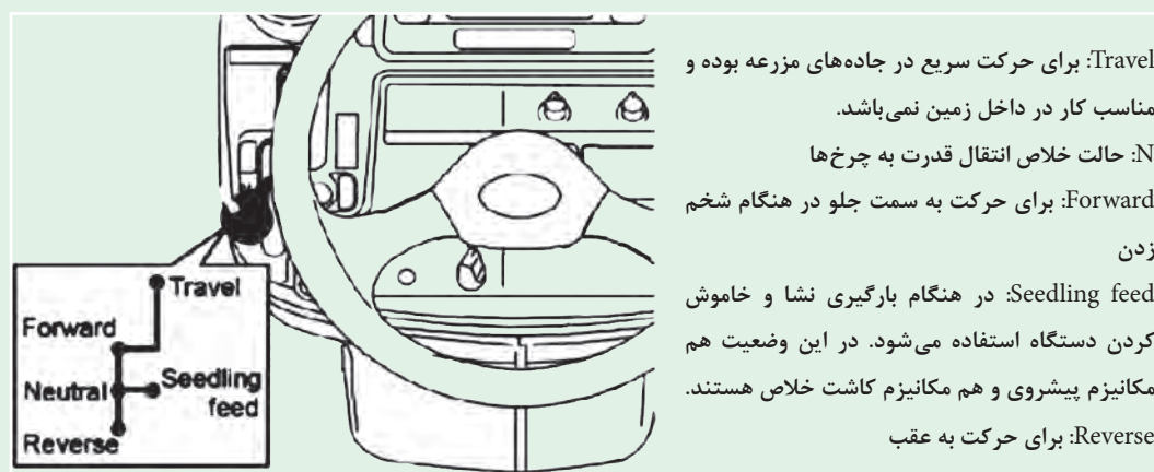
شکل ۱۹- شماتیک آرایش دنده‌های نشاکار یا نمار
