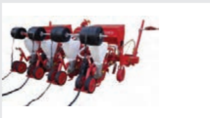
شکل ۱۴- استقرار نوار تیپ با ماشین کاشت
