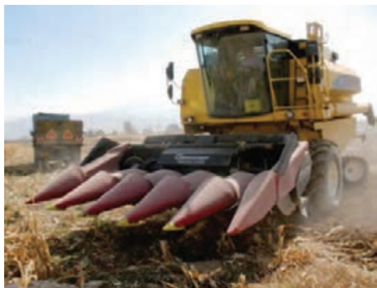
شکل ۱۲- کمباین دارای هد مخصوص برداشت ذرت دانه‌ای
