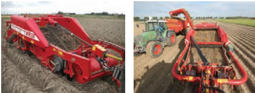
شکل ۲۷- برداشت سیب‌زمینی با دستگاه کمباین
