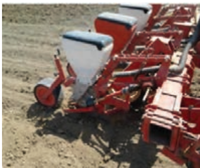
شکل ۱۴- کشت سویا با ردیف‌کار پنوماتیک دوردیفه
