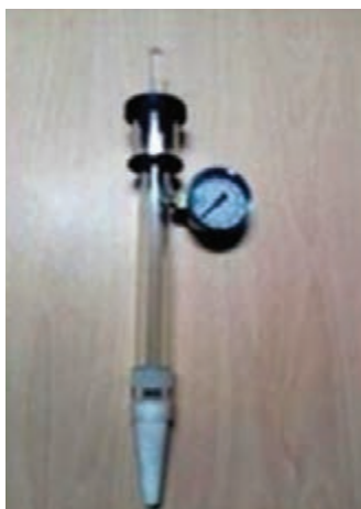
تانسیومتر آنالوگ مدل آب ۳۰ سانتی‌متری
