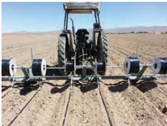
شکل ۱۸- استفاده از تیپ بعد از کاشت برای آبیاری قطره‌ای سیب‌زمینی
