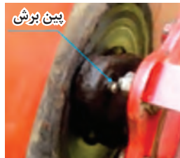
شکل ۱۱- پین برشی و کلاچ ایمنی در دستگاه بسته‌بند
