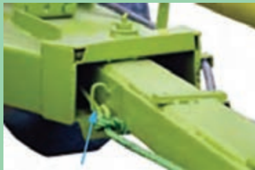
شکل ۷۰- طناب آزادکننده پین
