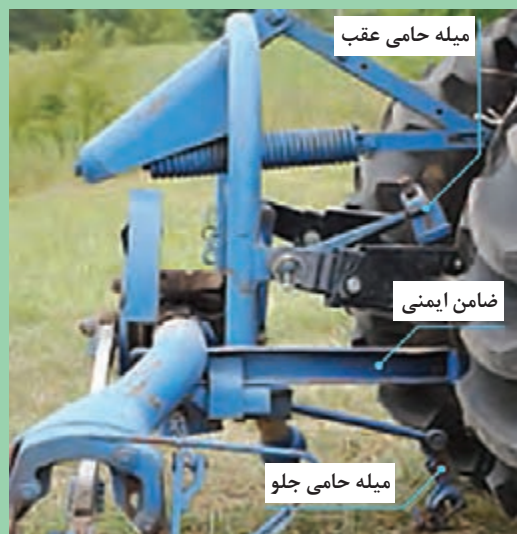
شکل ۲۱- نحوه اتصال دروگر شانه‌ای به تراکتور
