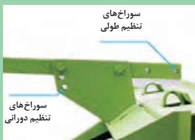
شکل ۵۱- هدایت کننده علوفه و پیچ‌های تنظیم آن
