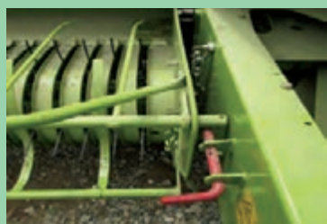
شکل ۱۵- پین نگهدارنده بردارنده
