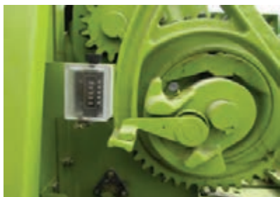
شکل ۲۶- شماره‌انداز بر روی دستگاه بسته‌بند
