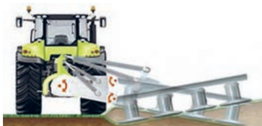
شکل ۱۲- حالت‌های کاری دروگر استوانه‌ای در شیب
