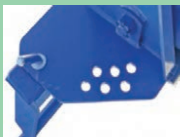
شکل ۱۳- صفحه سوراخدار روی شاسی شانه خورشیدی
