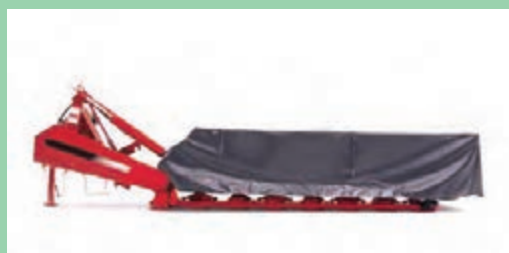
شکل ۱۰- حفاظ دستگاه دروگر استوانه‌ای و بشقابی
