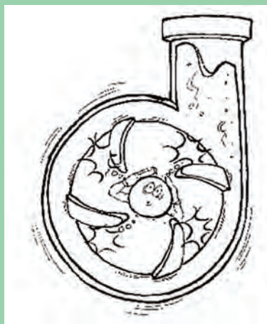
شکل ۱۵- کاویتاسیون در پروانه پمپ
