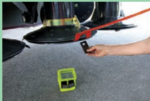
شکل ۲۰- نحوه تعویض تیغه در دروگر استوانه‌ای
