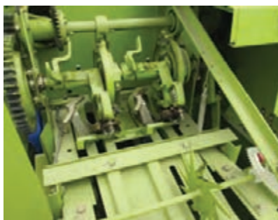
شکل ۲۴- چرخ دنده قطعی جهت تنظیم طول بسته در دستگاه بسته‌بند
