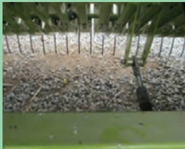
شکل ۲۲- جک هیدرولیکی جهت تنظیم ارتفاع واحد بردارنده
