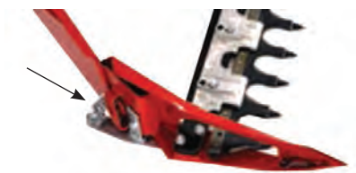
شکل ۳۱- کفشک تنظیم ارتفاع برش
