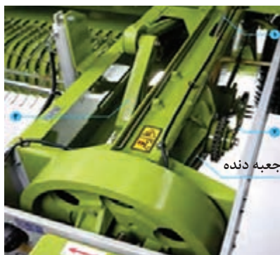
شکل ۱۲- مسیر انتقال توان در دستگاه بسته‌بند
