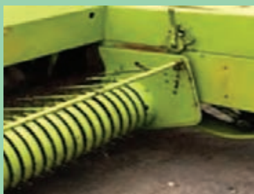
شکل ۲۰- تنظیم ارتفاع بردارنده
