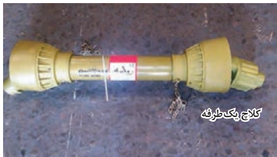
شکل ۱۱- گاردان یک نوع دروگر استوانه‌ای همراه با کلاچ یک طرفه
