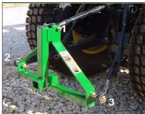
شکل ۸- نقاط اتصال سه گانه تراکتور
