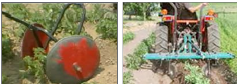
شکل ۷- خاک دهی پای بوته با مرکز کش دیسکی (بوته ها بین دو دیسک قرار می گیرند).
