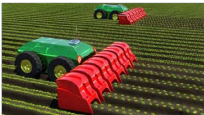
شکل ۱۷- ماشین تنک‌کننده کاهو
