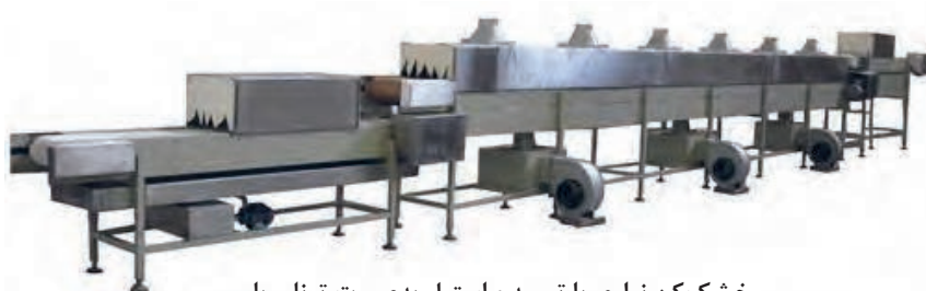
خشک کن نواری با تسمه و استیل به صورت تونلی با هوای گرم و درجه حرارت قابل تنظیم ۵۰ تا ۹۰ درجه سانتی گراد
