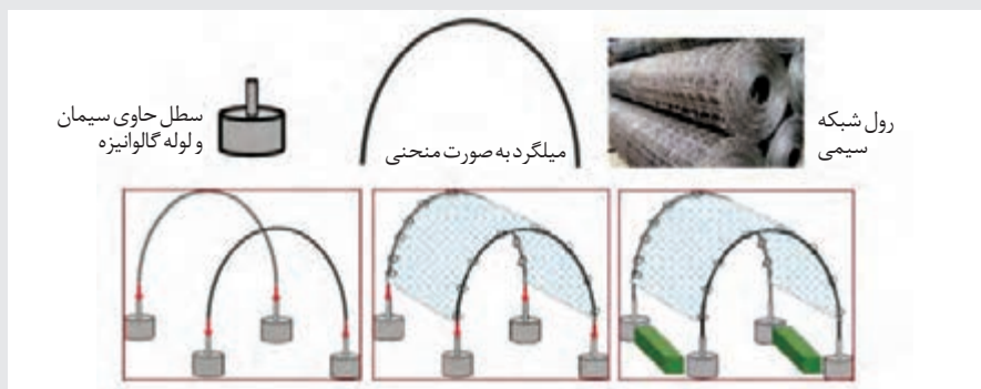
مراحل ساخت تونل سبز توسط شبکه‌های سیمی
