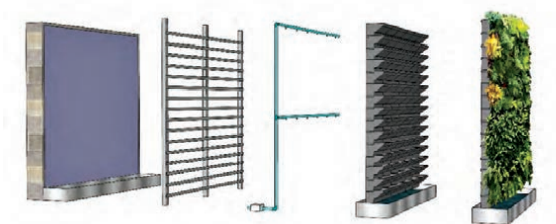
نحوه اتصال گلدان‌های کاشت روی شبکه‌های فلزی
