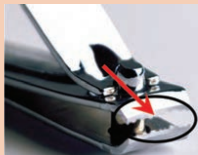
شکل ۵-۱۸- لبه های برنده خراب شده در ناخن گیر و دم باریک
