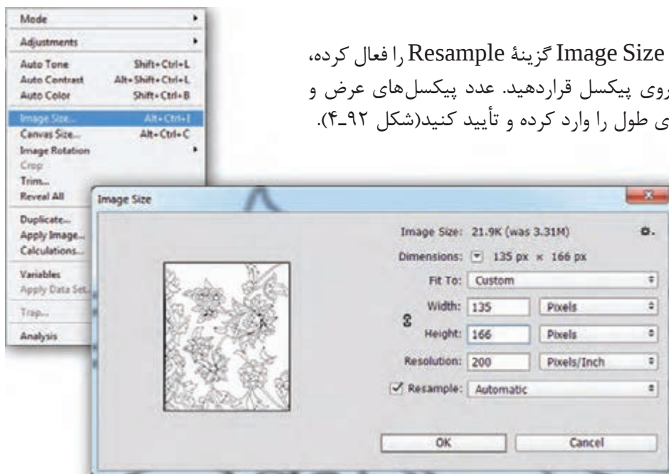
شکل ۹۲-۴ - تنظیم تعداد پیکسل‌های طول و عرض نقشه در پنجره Image Size
