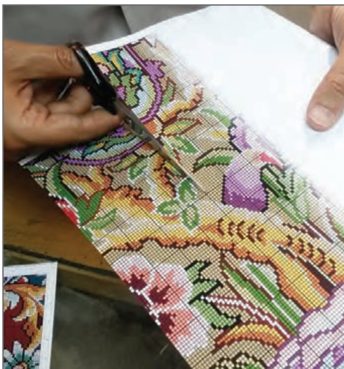
شکل ۴-۵- برش نقشه با قیچی (روش غلط)
