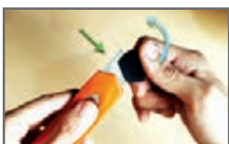
شکل ۱۱-۱- روش شکستن تیغه کاتر
