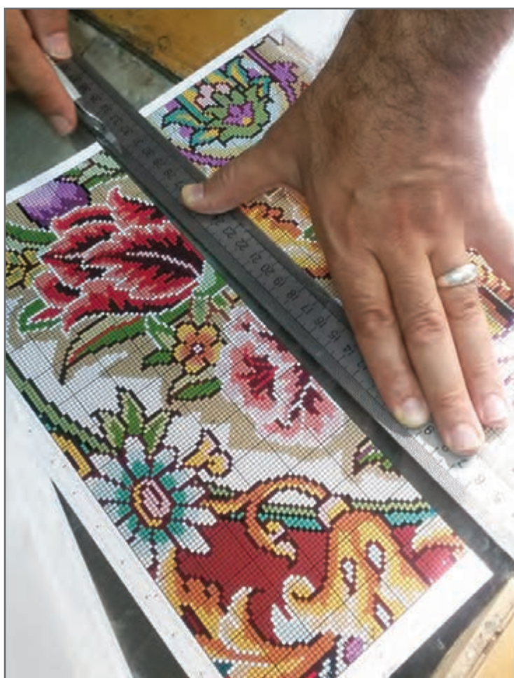
شکل ۲-۵- برش نقشه با ابزار کاتر (روش صحیح)
