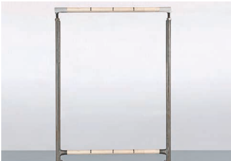
▲ شکل ۱-۲۱ علامت گذاری فاصله‌های ده سانتی متری روی سر دار و زیر دار
