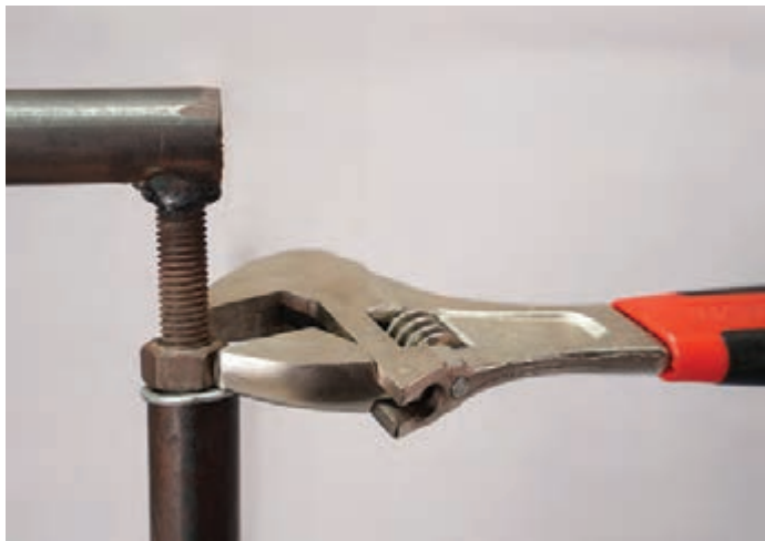
▲ شکل ۲-۲۴ سفت کردن مجدد پیچ‌های سر دار
