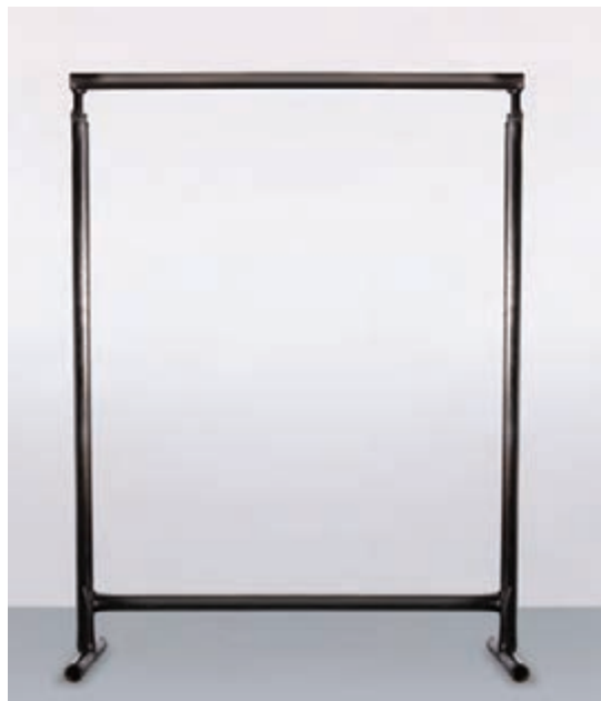
شکل ۱-۱ دار ساده (بدون فندک)
