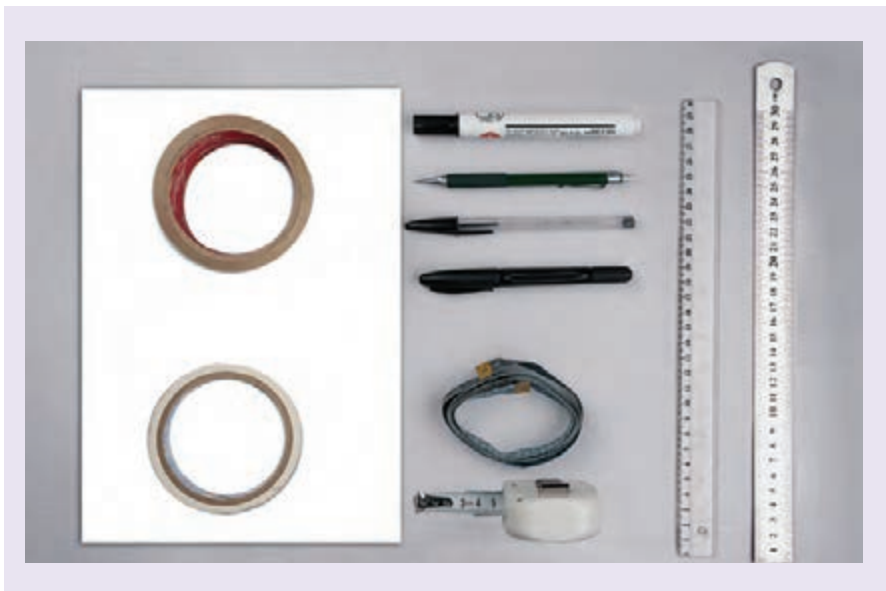
▲ شکل ۱-۱۵ ابزار سیه‌بندی
