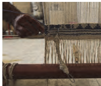
شکل ۷۶- عبور حلقه از داخل سوزن
