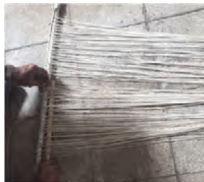
شکل ۳۷- قرار دادن چوب‌های گُرت در داخل چله
