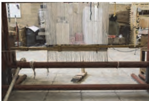
شکل ۷۷- مهار پهنابند و بستن آن به کار
