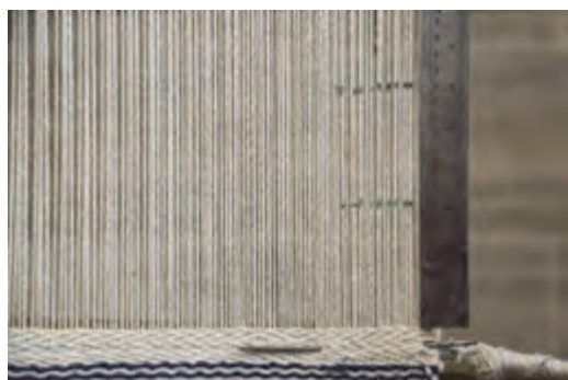
شکل ۸۱- محل برش و بافت زیلوی بعدی
