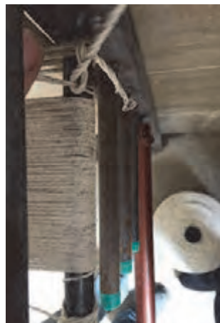
شکل ۳۳- عبوردادن نخ به صورت حلقه‌ای در سرکار شکل ۳۴- عبور دادن نخ به صورت زیگراگ در ته کار
