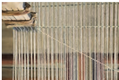
شکل ۷۱- کوبیدن پود به وسیله پنجه
