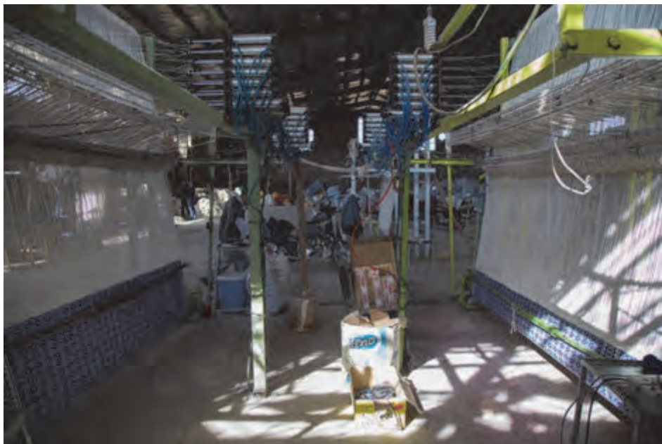
شکل ۲۷- دستگاه مکانیکی بافت زیلو
