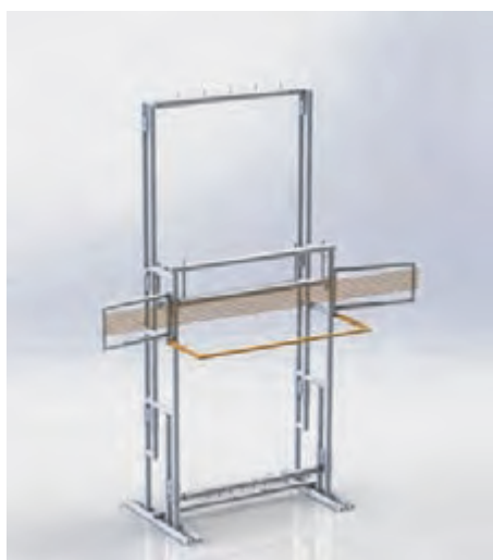
شکل ۶۵- قرار دادن میلۀ پشت بند
