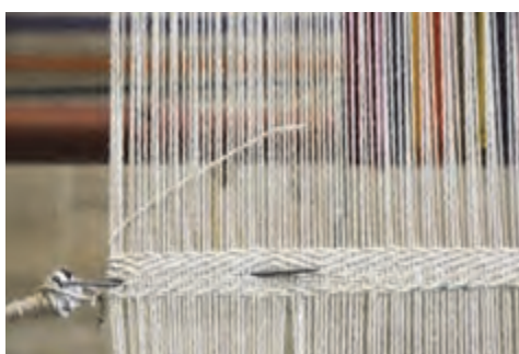
شکل ۷۳- اتمام بافت سرپر
