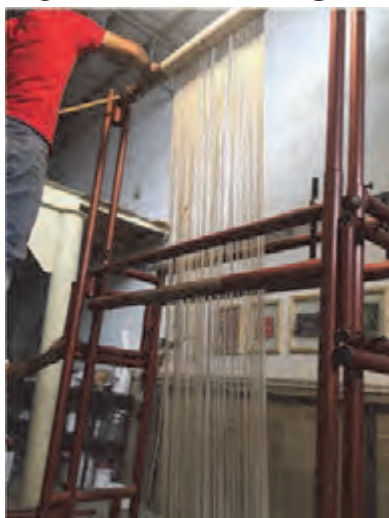
شکل ۴۵- برگرداندن چله‌ها بر روی تیر بالا
