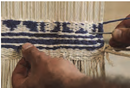
شکل ۷۵- قرار دادن سوزن مهار در داخل بافته
