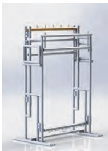
شکل ۶۱- قرار دادن تیر بالا
