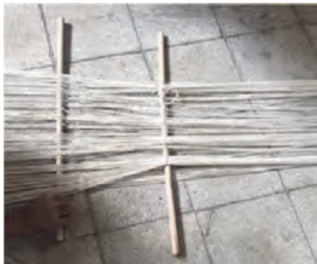
شکل ۳۷- قرار دادن چوب‌های گُرت در داخل چله
