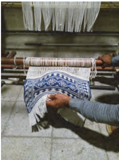
شکل ۸۵- باز کردن زیلو از روی تیر پایین
