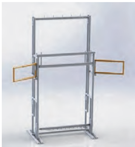
شکل ۶۳- باز کردن چوشلیت (مهار شلیت)
