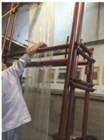
شکل ۴۷- پایین آوردن چوب مهار و مرتب کردن تارها
