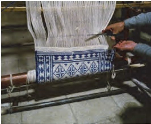
شکل ۸۳- چیدن یا برش دادن زیلو
