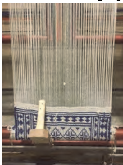
شکل ۷۹- جمع کردن زیلو بر روی تیر پایین
