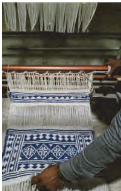
شکل ۸۶- آزاد کردن زیلو از تیر پایین
