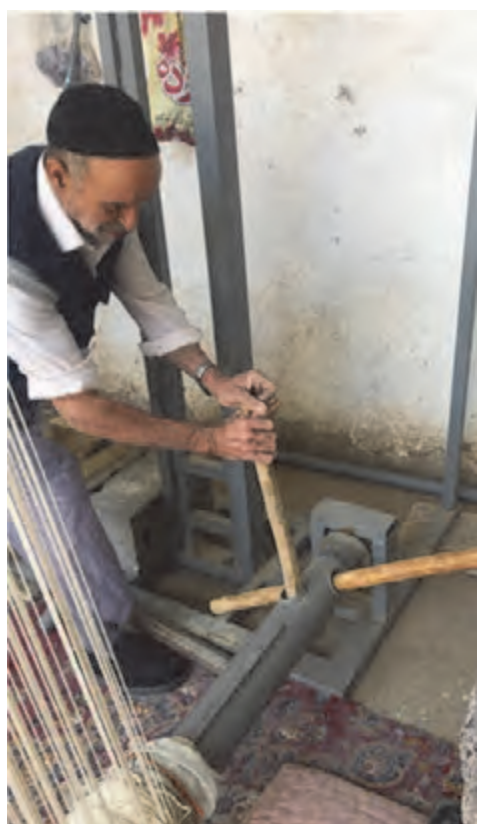
شکل ۶۶- تنظیم فشار چله‌ها
