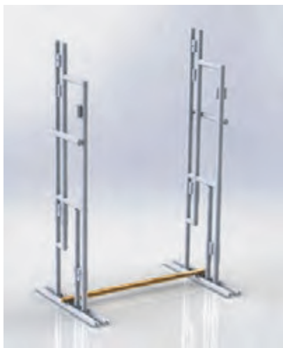
شکل ۵۷- قرار دادن مهار پایین
