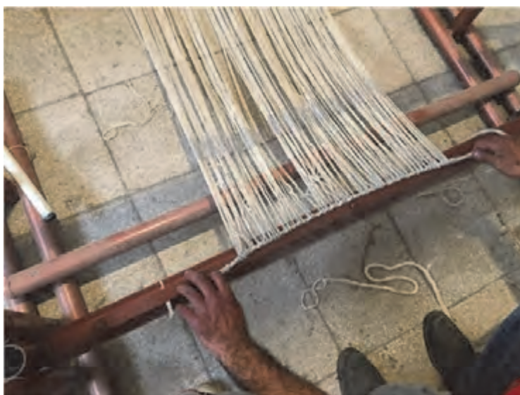
شکل ۴۱- بستن چله بر روی تیر پایین
