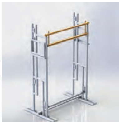
شکل ۵۹- قرار دادن مهار بالای جلو
