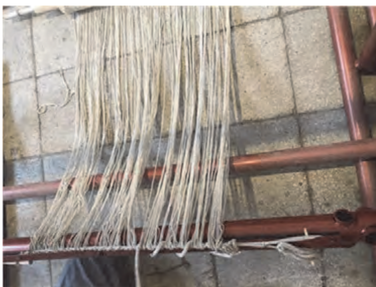
شکل ۴۲- ته دوزی کردن تارها
