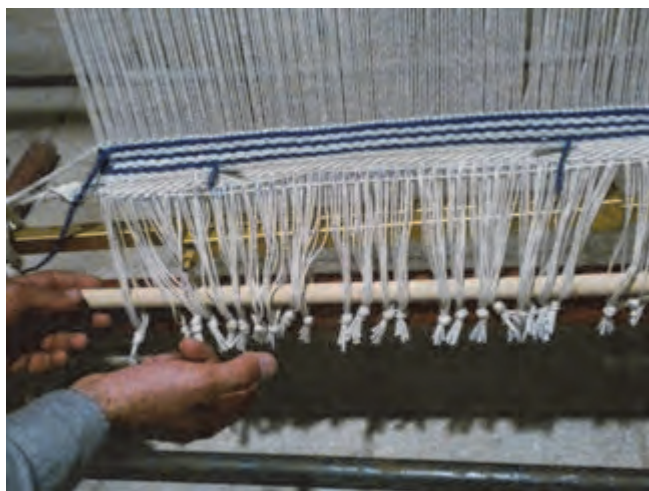
شکل ۸۹- قرار دادن چوب مهار
