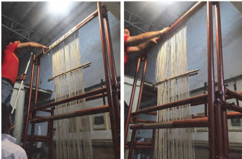
شکل ۴۳- بستن چله‌ها بر روی تیر بالا
