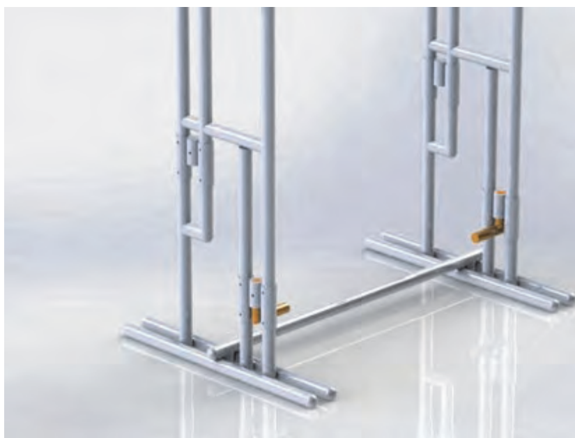
شکل ۶۸- قطعه (L) مانند دستگاه برای نصب تیر بر روی اسون
