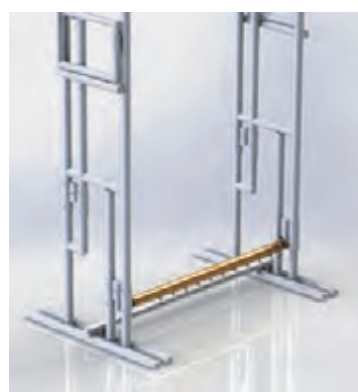
شکل ۵۸- قرار دادن تیر پایین
