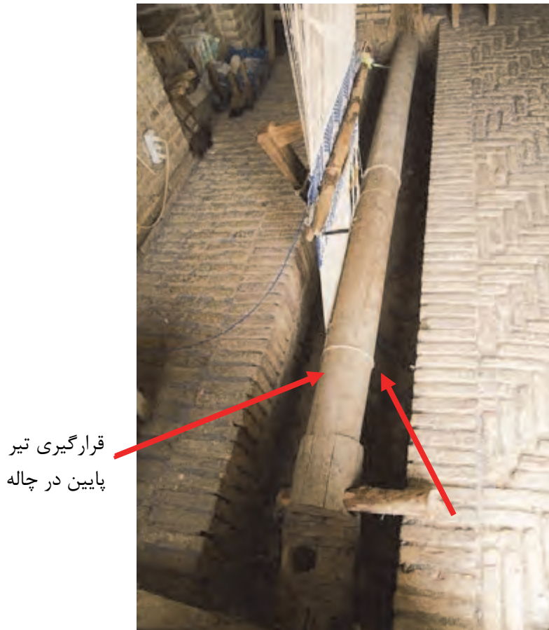
شکل ۴۷- چاله، محل قرارگیری دستگاه زیلوبافی چوبی
