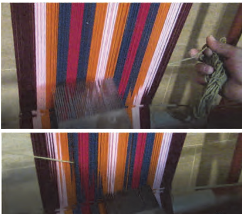
شکل ۲۲- کوبیدن پود در هنگام بافت
