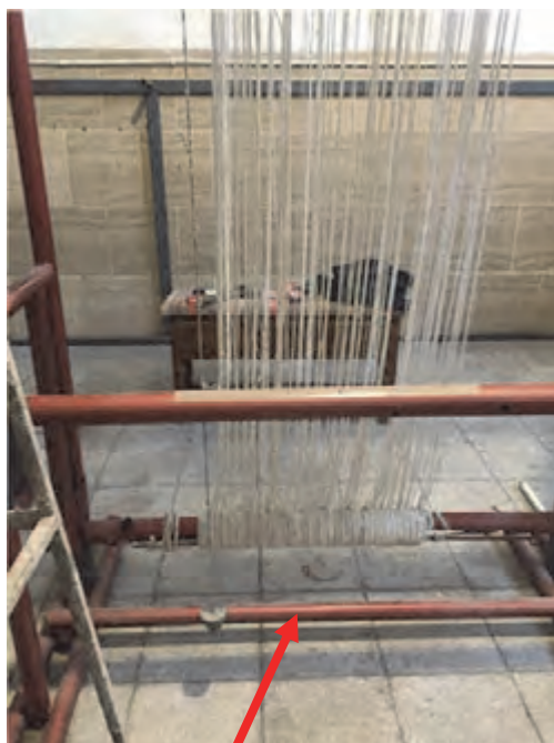
شکل ۴۴- تنظیم چله‌ها به کمک شاغول
