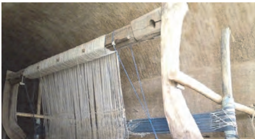
شکل ۳۰- تیر بالا در دستگاه زیلوبافی
