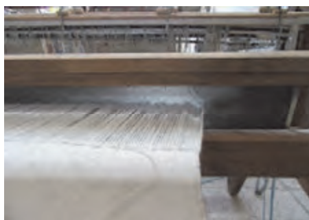
شکل ۱۸- شانه دستگاه بافت پارچه
