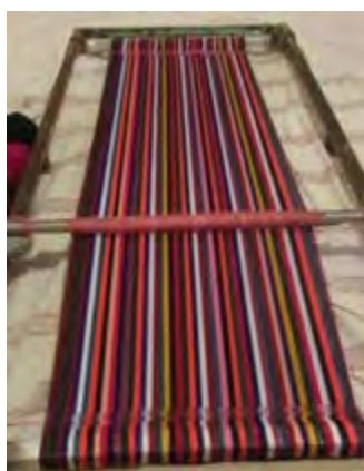
شکل ۷- دستگاه جاجیم‌بافی افقی
