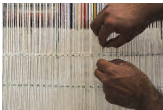
شکل ۷۲- مرتب کردن و تنظیم فاصله چله‌ها
