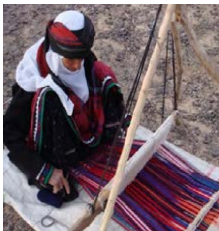
شکل ۲۳-۱ دستگاه چوبی بافت جاجیم
