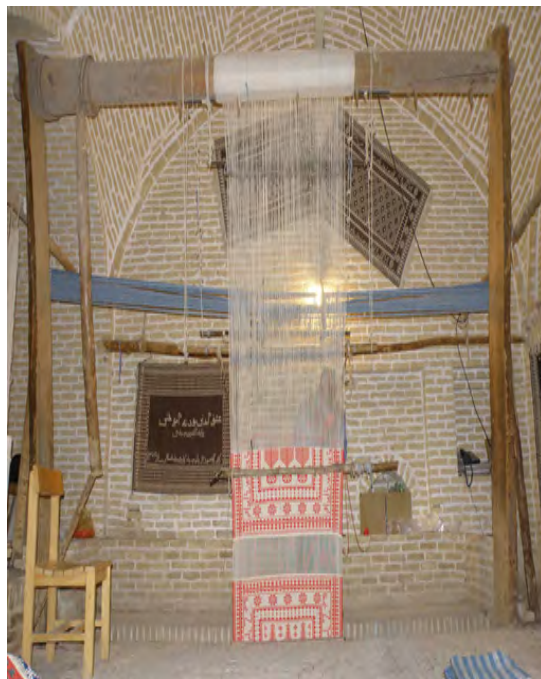
شکل ۲۲-۱ دار چوبی و ثابت برای بافت زیلو
