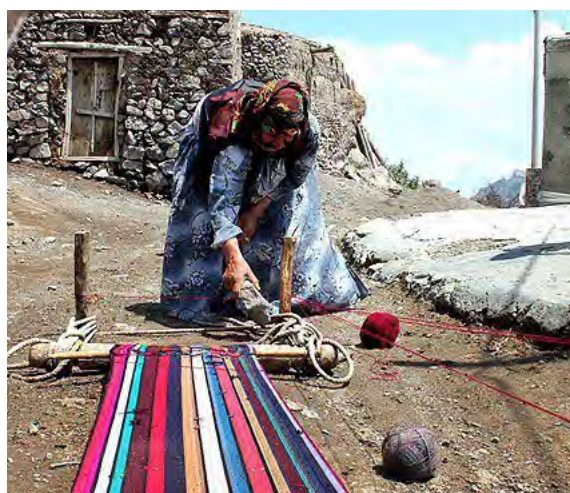
شکل ۳۶-۱ دستگاه چوبی جاجیم بافی (افقی)
