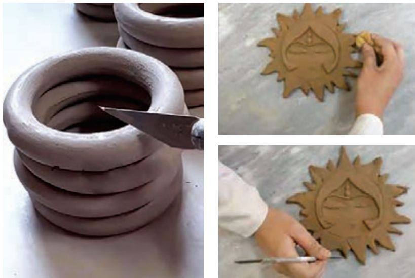
شکل ۸- پرداخت محصولات سرامیکی با ابزارهای مختلف
