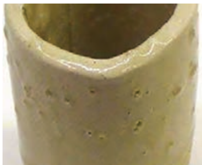
شکل ۴۴- تاول زدن لعاب
