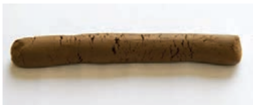
گل با شکل‌پذیری نامناسب – دارای ترک
