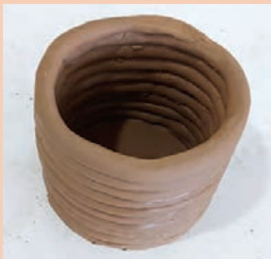
شکل ۲۸- نمونه شکل دهی شده به روش فنیله‌ای
