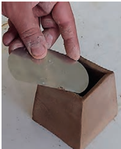
شکل ۲۳- پرداخت لبه نمونه با لیس
