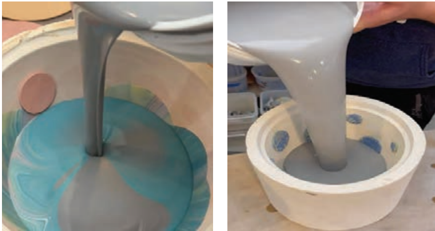
شکل ۲۷- تزیین قطعه با استفاده از گل رنگی داخل قالب
