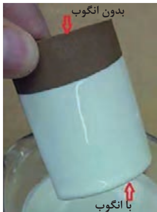
شکل ۱۳- قطعه بدون انگوب و بعد از اعمال انگوب
