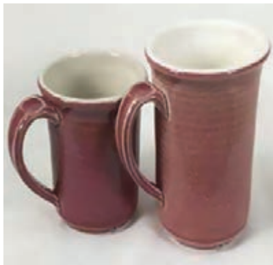
شکل ۳۵- لعاب با دمای پخت نامناسب
