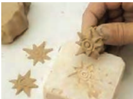
شکل ۱۱- فشار دادن مقداری گل درون قالب
