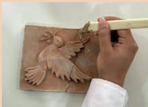
شکل ۴۱- ترمیم قطعه بیسکویت شده معیوب
