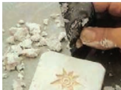
شکل ۱۰- تراشیدن قالب گچی
