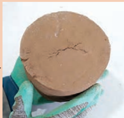
شکل ۲۸- نمونه شکل دهی شده به روش فنیله‌ای
