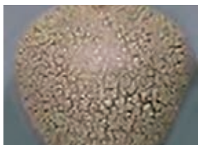
شکل ۴۱- عیب خزیدگی در لعاب
