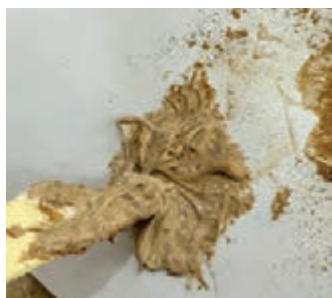
شکل ۳۸- مخلوط کردن چسب چوب و پودر بدنه
