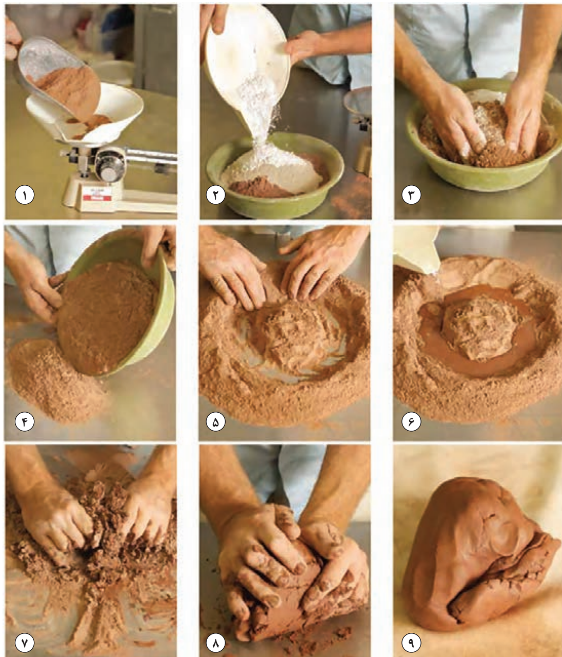
شکل ۳۰- فرایند تولید گِل به روش دستی
