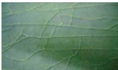
شکل ۳۶- عیب ترک برداشتن لعاب
