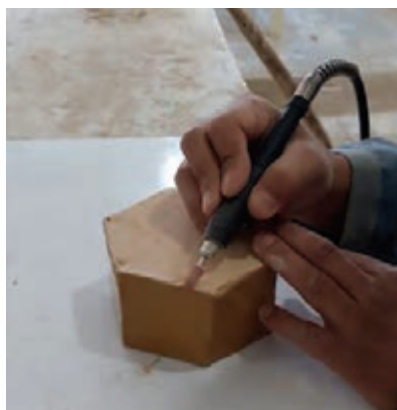
شکل ۳۱- برطرف کردن ناهمواری‌های جزئی در انتهای قطعه
