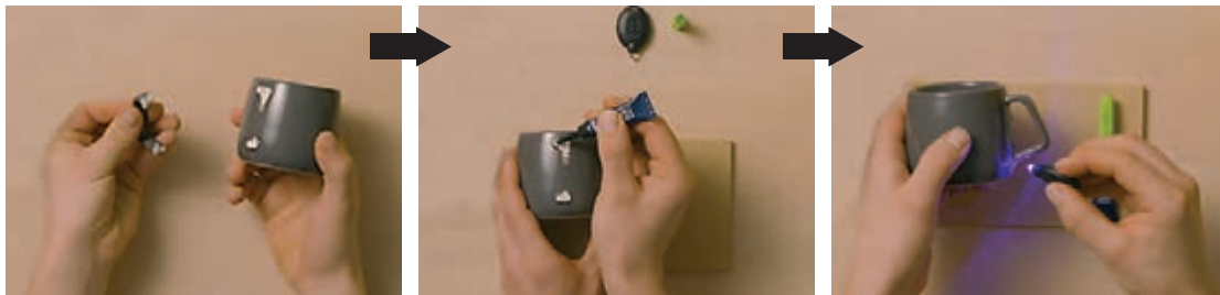
شکل ۵۱- مراحل ترمیم قطعه سرامیکی با استفاده از چسب فرابنفش
