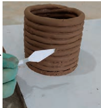
شکل ۱۷- برداشتن اضافات گل با استفاده از ابزار پلاستیکی
