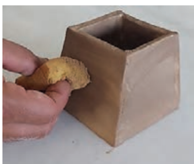
شکل ۲۴- صاف و صیقلی کردن با ابر مرطوب
