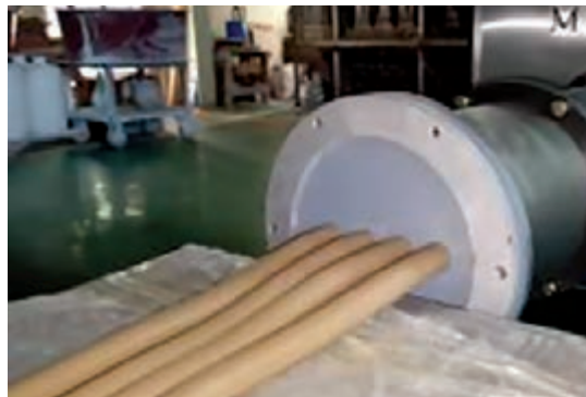
شکل ۵۵- قالب دستگاه اکسترودر
