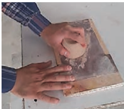
شکل ۱۳- یکدست کردن لبه کاسه با تخته سنباده
