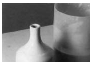
شکل ۲۸- قطعه لعاب زده‌شده به روش غوطه‌وری
