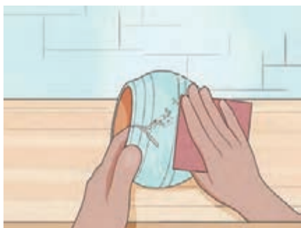
شکل ۴۷- سنباده‌زنی و پرداخت سطح ترمیم شده
