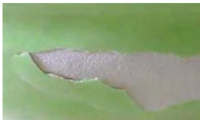
شکل ۳۷- عیب پوسته‌شدن لعاب
