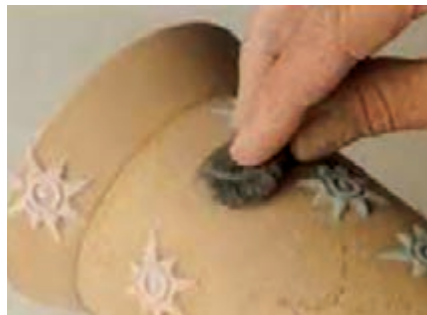
شکل ۱۲- پرداخت بدنه پس از قرار دادن طرح
