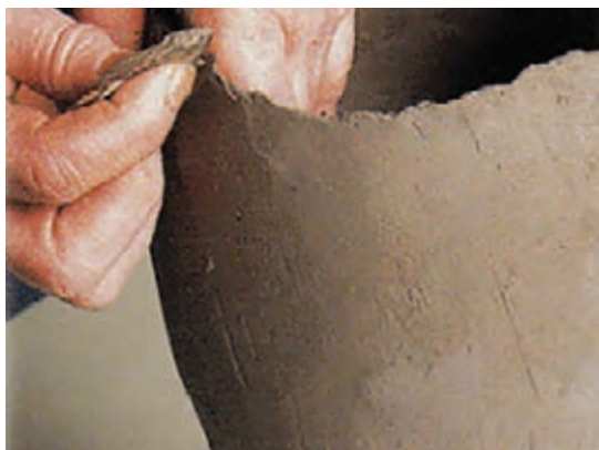
شکل ۱۷- مراحل شکل‌دهی گلدان به روش فتیله‌ای
