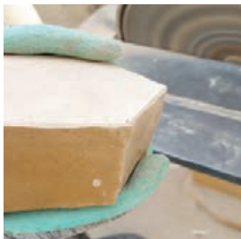
شکل ۳۳- فارسی بر کردن محل اتصال در انتهای قطعه
