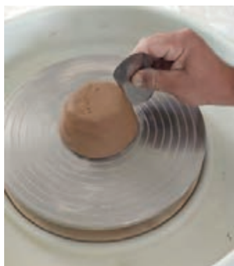
شکل ۹- پرداخت سطح بیرونی کاسه با لیسه فلزی
