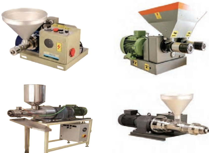
مدلی از دستگاه پرس که در بخشی از سیلندر برای استحصال روغن بیشتر ابزار گرم‌کننده (المنت) کار گذاشته شده است.
