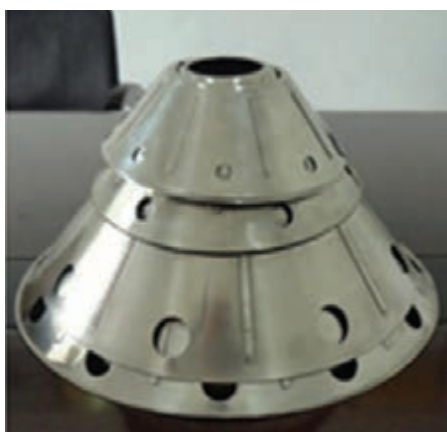
شکل ۵-۶- سپراتور و صفحات داخلی آن
