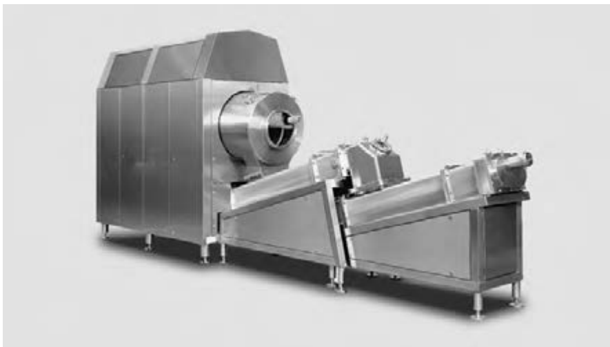
شکل ۵-۹- دستگاه تولید مداوم کره
