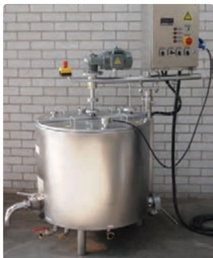
شکل ۱-۱۷- سیستم پاستوریزاسیون غیرمداوم
