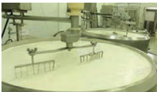
شکل ۴-۴- آبگیری و برش لخته
