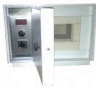
شکل ۲-۱۶- وسایل مورد استفاده برای آزمایش اندازه گیری خاکستر
