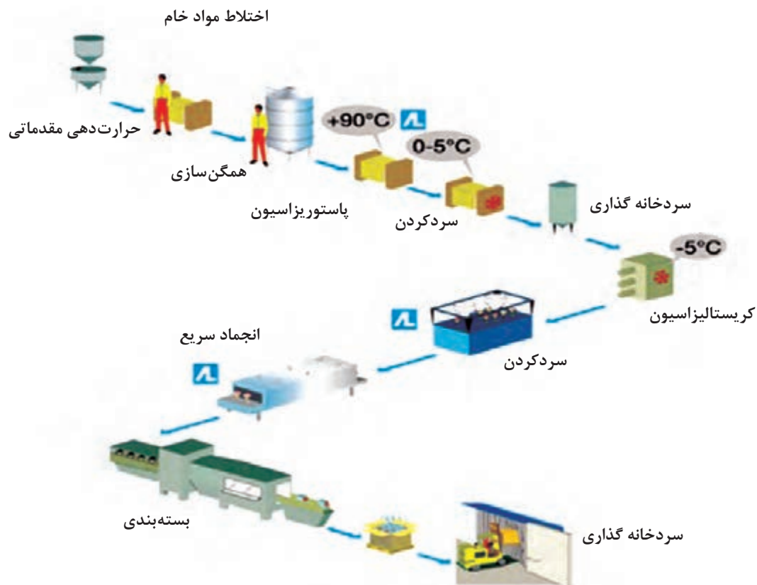
شکل ۳-۸ - فرایند تولید بستنی
