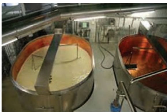
شکل ۳-۳- مخزن اختلاط بستنی
