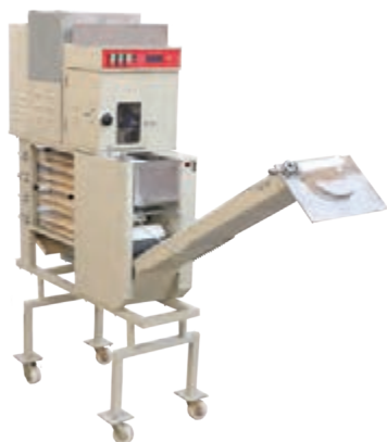
شکل ۱۰- تصاویر دستگاه چانه گیر
