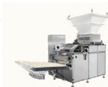
شکل ۱۰- تصاویر دستگاه چانه گیر
