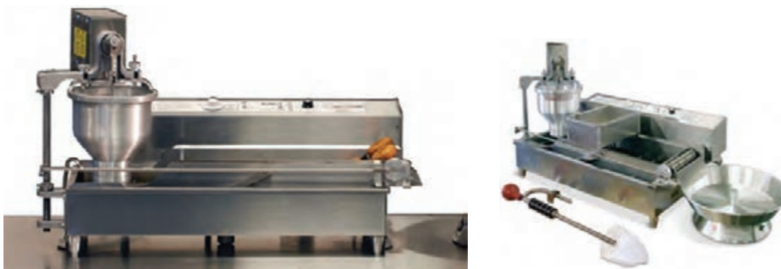
شکل ۸- تصاویر دونات‌زن اتومات به همراه سرخ‌کن
