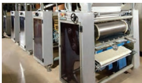
شکل ۶- دستگاه لایه کن خمیر
