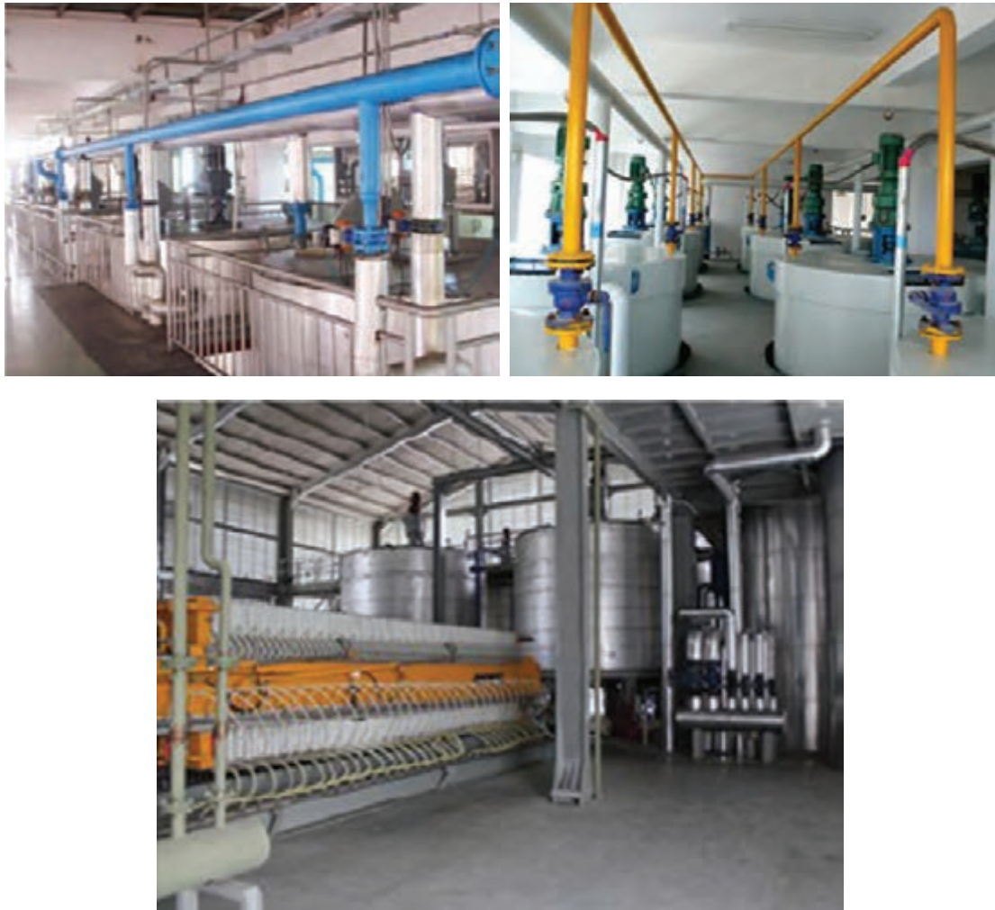
شکل ۱۰- سیستم تجهیزات جزء به جزء کردن روغن
