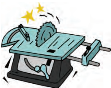
شکل ۲۹- شرایط نایمن - نبود حفاظ در محل دستگاه
