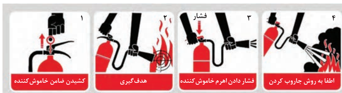
شکل ۱۲- مراحل استفاده از کپسول آتش‌نشانی
