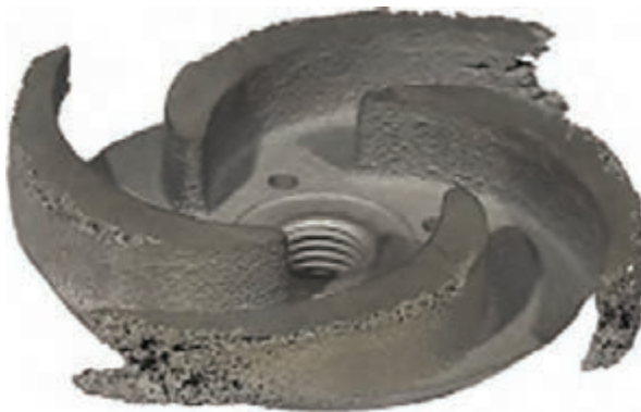
شكل ۲۲- آسیب دیدگی پروانه پمپ در اثر پدیده کاویتاسیون
