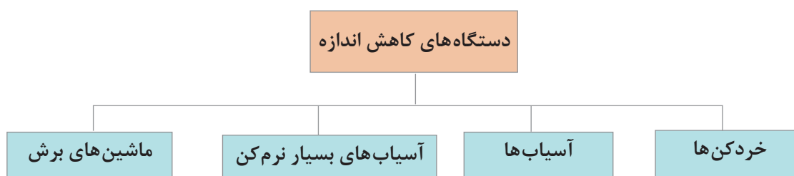
شکل ۴۲- طبقه‌بندی دستگاه‌های کاهش اندازه
