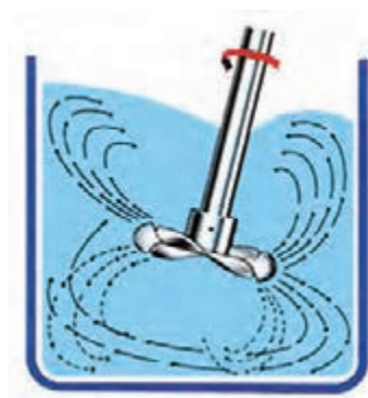
شکل ۳۱- قرار دادن همزن خارج از مرکز و افزایش آشفتگی سیال
