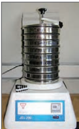
ب) مجموعه الک‌ها بر روی دستگاه لرزاننده
