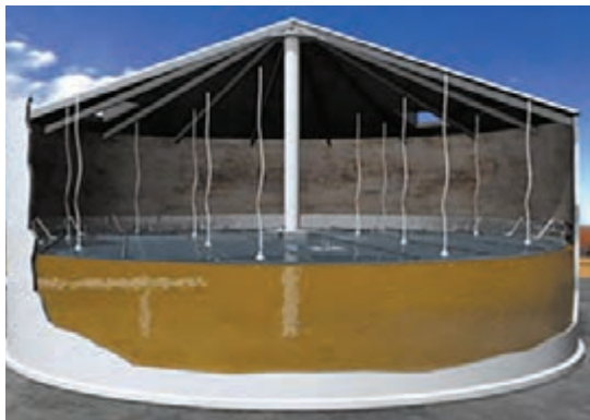
شکل ۱۹- مخازن سقف شناور درونی
