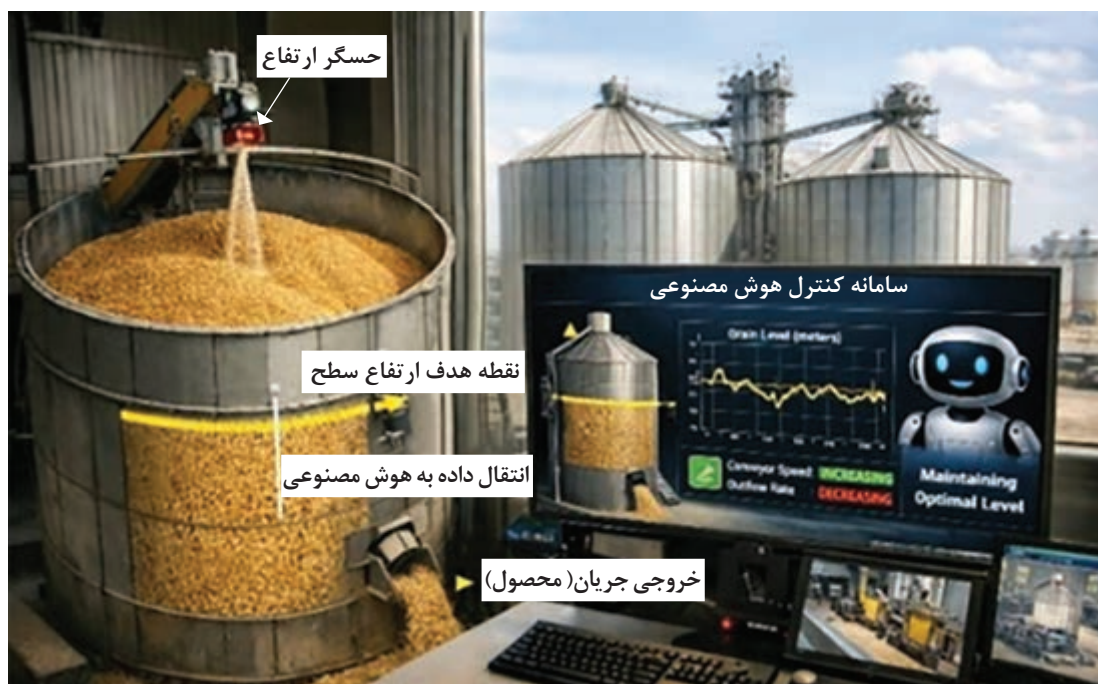
شکل ۲۴- کنترل ارتفاع سطح سیلوی گندم با هوش مصنوعی
