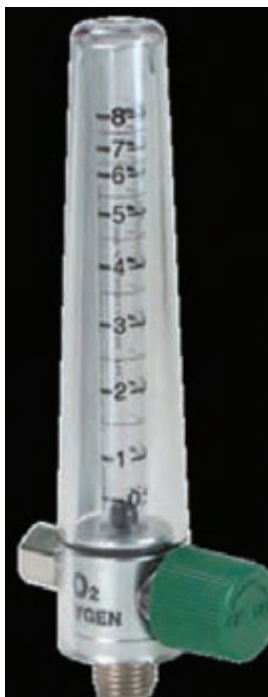
شکل ۸- روتامتر اندازه‌گیری جریان اکسیژن
