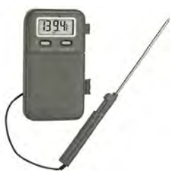
شکل ۲۴- نشانگر دیجیتالی دما (مصارف صنعتی)
