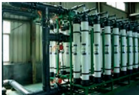
شکل ۱۰- نمایی ساده و واقعی از فرایند اولترافیلتراسیون
