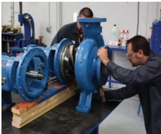
شکل ۲- تعمیر اساسی پمپ در کارگاه مکانیک
