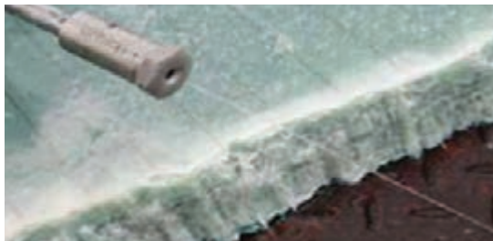
شکل ۱۵- نازل فشار قوی جت آب صنعتی با قدرت تخریب زیاد
