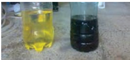
شکل ۱۸- مقایسه چشمی روغن تمیز و کثیف
