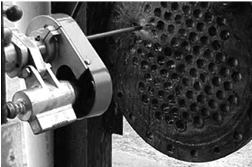
شکل ۲۰- دستگاه تزریق هیدروفرز مکانیکی
