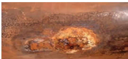
شکل ۲- برآمدگی و خوردگی ناشی از تشکیل رسوب
