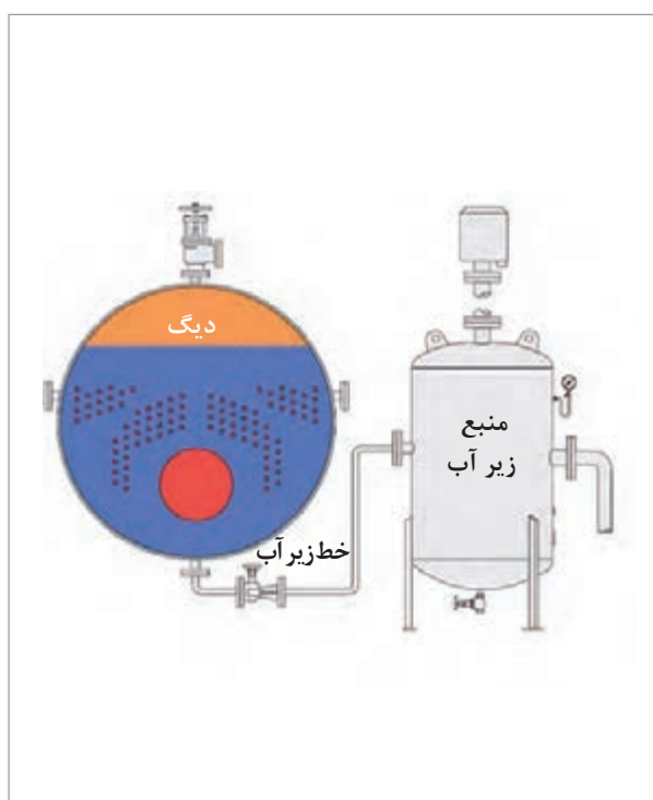
شکل ۸- نمایش جریان دوریز دیگ بخار (زیر آب یا بلودان)
