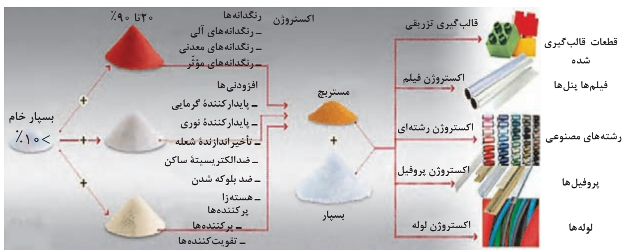
شکل ۶- فرایند تولید مستریج و قطعات بسپاری
