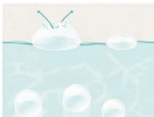
شکل ۱۰- در حضور مواد ضد کف، حباب به راحتی می‌ترکد.
