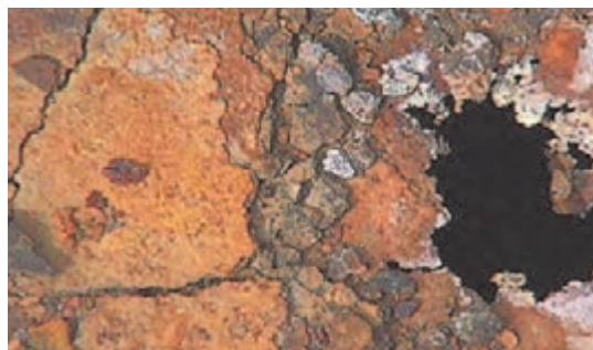
شکل ۶- نمونه‌هایی از خوردگی در دمای بالا
