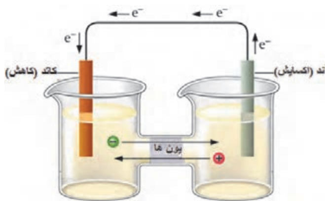
شکل ۹- نمایی از یک پیل مولد الکتریسیته
