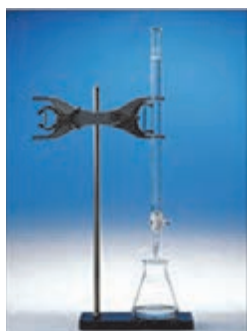
شکل ۱۱- طرح ساده‌ای از آزمایش سنجش حجمی
