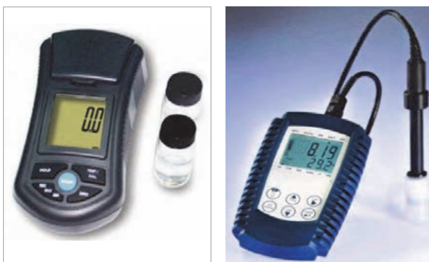
شکل ۲- چند نمونه از دستگاه کدورت‌سنج با نمونه‌های مربوطه
