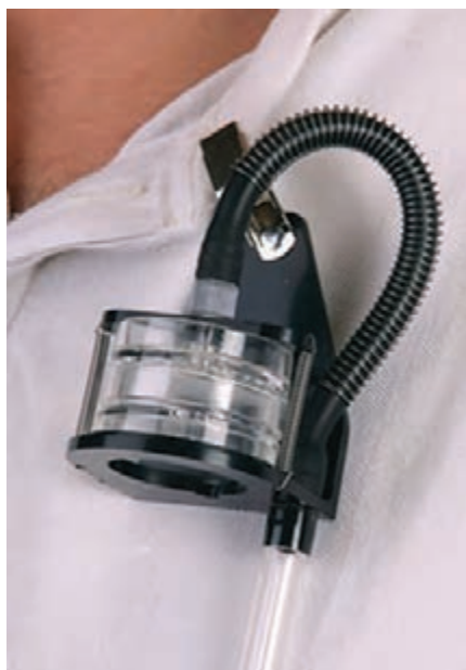
نصب صافی در ناحیه تنفسی شخص نمونه گیر
