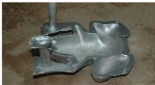
شکل ۲- یک قطعه خام با ناصافی‌ها در سطح
