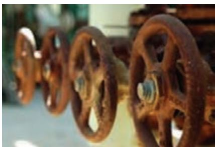
شکل ۵- نمونه‌هایی از خوردگی در قطعه‌های فلزی
