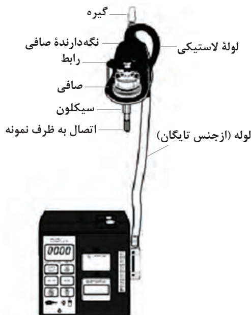
شکل ۲۳- شیوه اتصال صافی به پمپ نمونه گیر هوا
