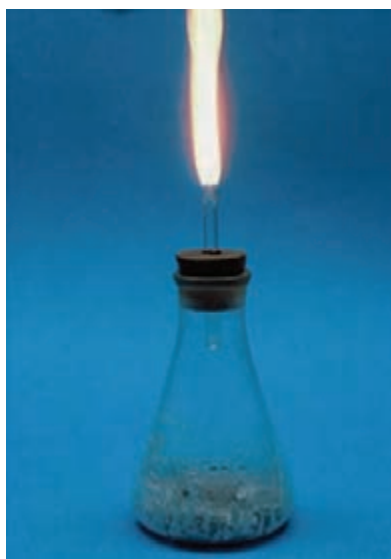
شکل ۹- واکنش کلسیم کربید با آب، گاز اشتعال‌پذیر استیلن را تولید می‌کند.
