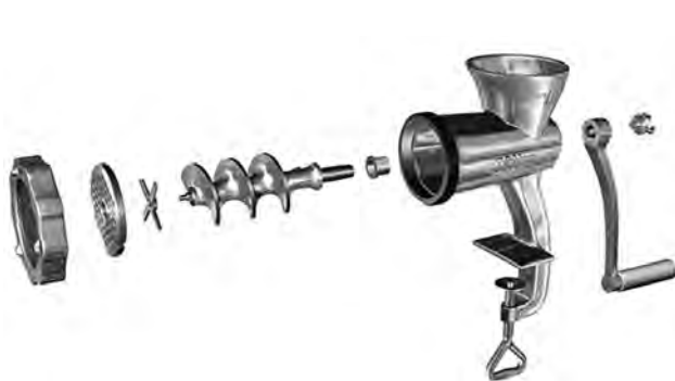
شکل ۶۷- تصویر سه بعدی انفجاری چرخ‌گوشت دستی
