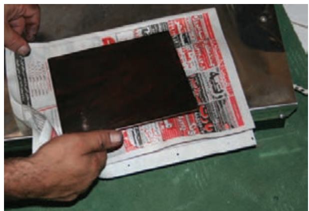
تصویر ۱۸۲- لازم است کلیشه در دو مرحله (قبل از مرکب زدن و پس از پاک کردن مرکب‌های اضافه یعنی درست قبل از چاپ) روی هیتز گذاشته شده و گرم شود.
