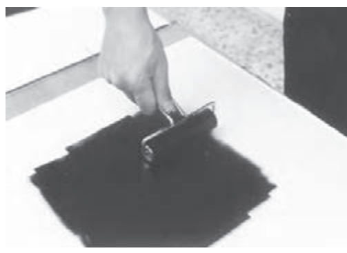
۲ - مقداری از مرکب را به کمک غلتک در محدوده طرح پخش کنید.
