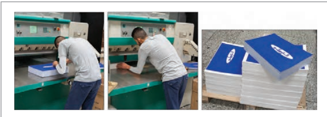
تصویر ۷ برش نهایی، کنترل ابعاد نهایی توسط برشکار طبق دستور کار و ماکت طراح
