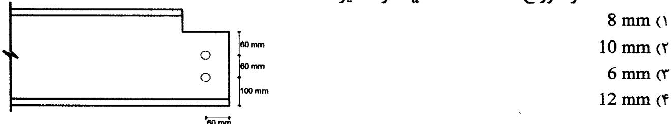
۳۱- اتصال نشان داده شده در شکل زیر مربوط به عضوی در یک سیستم باربر جانبی لرزه‌ای می‌باشد. چنانچه پیچ‌ها از نوع A490 با قطر 20 mm و سطح برش از محل دندانه‌ها عبور نماید و پیچ‌ها در یک ردیف در راستای نیرو بکار برده شوند، در طراحی به روش تنش مجاز حداقل تعداد پیچ لازم به کدامیک از مقادیر زیر نزدیکتر است؟
