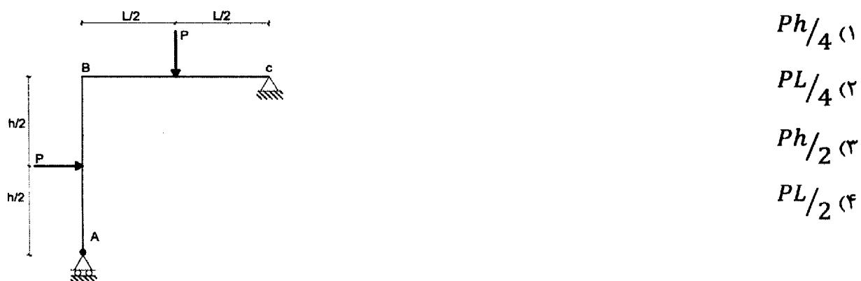
۲۵- در سازه نشان داده شده در شکل زیر، چنانچه تیرها به لحاظ محوری و خمشی صلب فرض شوند، حداکثر لنگر خمشی بوجود آمده در ستون AB به کدامیک از مقادیر زیر نزدیکتر است؟
